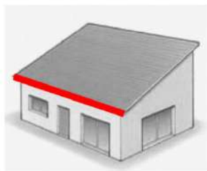
Égout du toit sur toiture mono-pente
