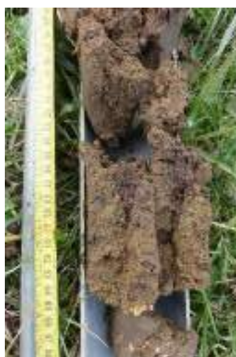
Sondage S7 (traces d'oxydation)
